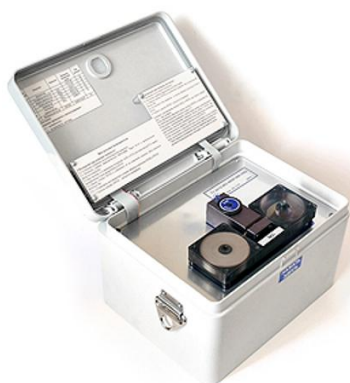
Рисунок 5.4 - Зовнішній вигляд газоаналізатора ГАНК-4.
