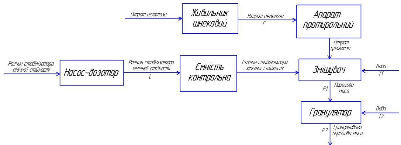
Рисунок 1.2 – Схема інформаційно-матеріальних потоків процесу пластифікації та гранулювання
