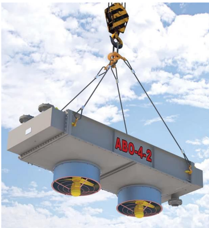
Рисунок 11 Блок повітряного охолодження АВО-4-2
