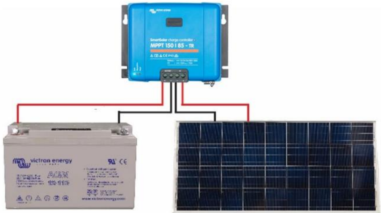
Рисунок 3.2 - Контролер заряду в з'єднанні з АКБ та фотоелектричним модулем
