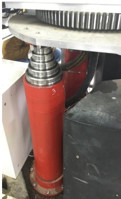
Рисунок 4.4 Механізм підйому поворотної платформи
