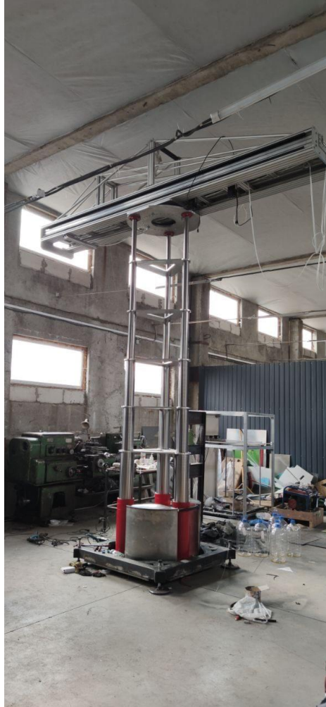
Рисунок 2.2 Прототип будівельного принтера радіального типу
