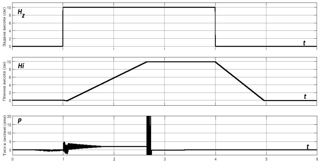
Рисунок 7.7 – Осцилограма висоти підйому штоків і тиску в системі в залежності від заданого значення
