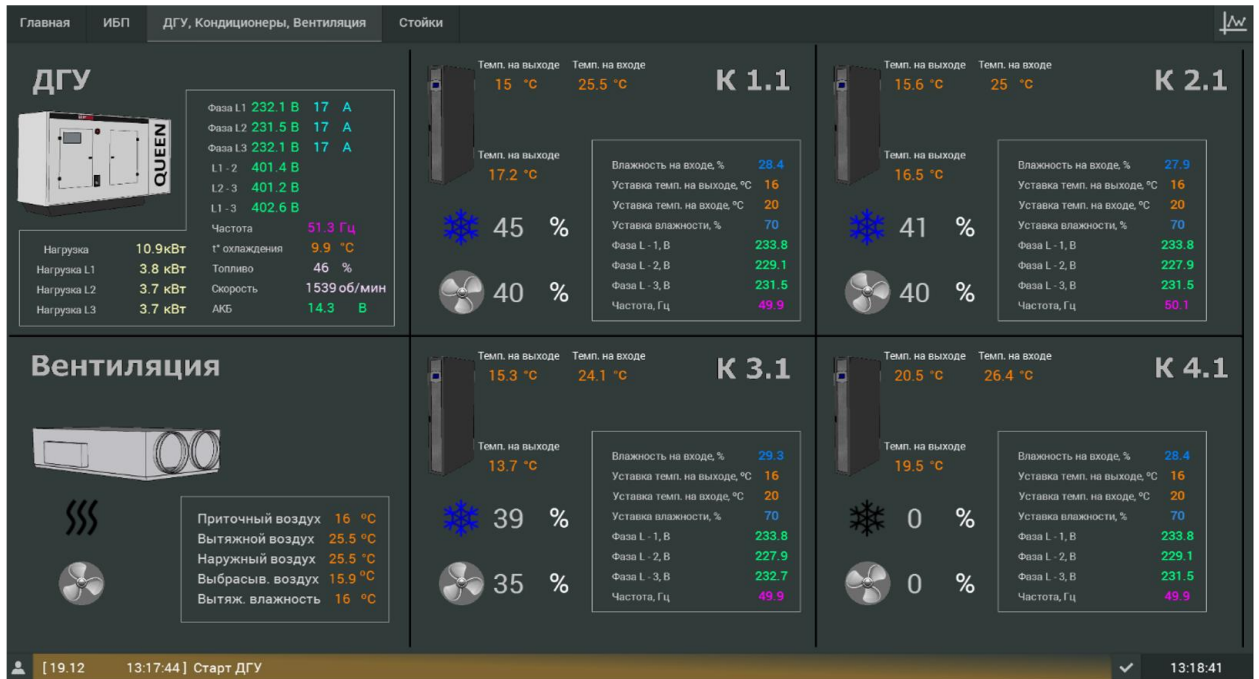
Рисунок 3.16 – Врзак інтерфейсу SCADA системи кліматозабезпечення ЦОД
