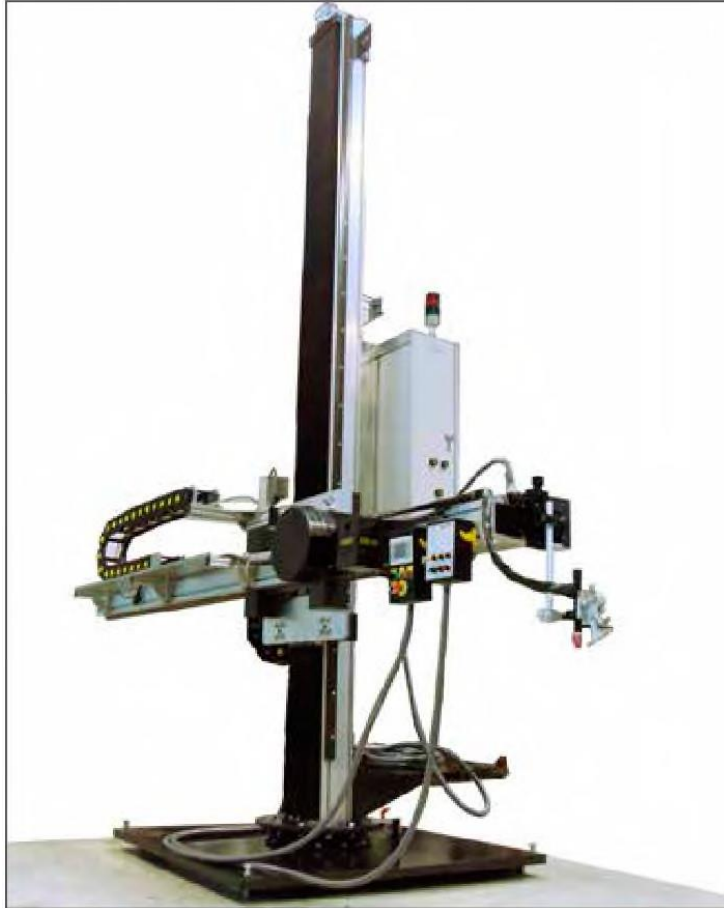
Рисунок 3.16 – Зварювальна колона типу AI Power Midi
