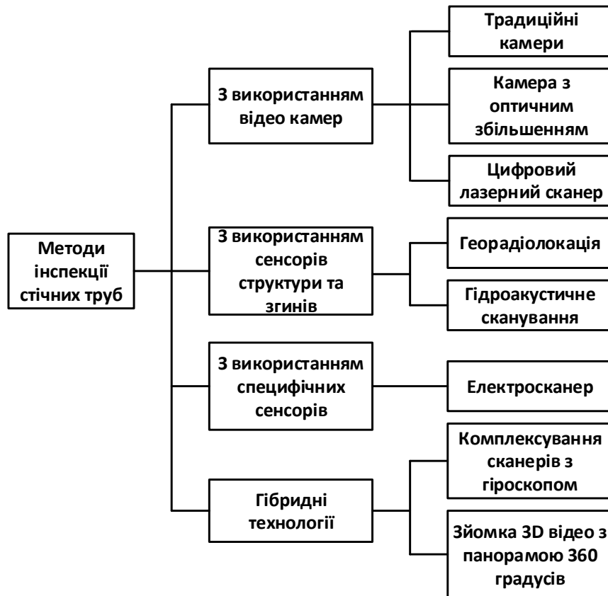
Рисунок 1.2 – Види інструментів інспекції трубопроводів
