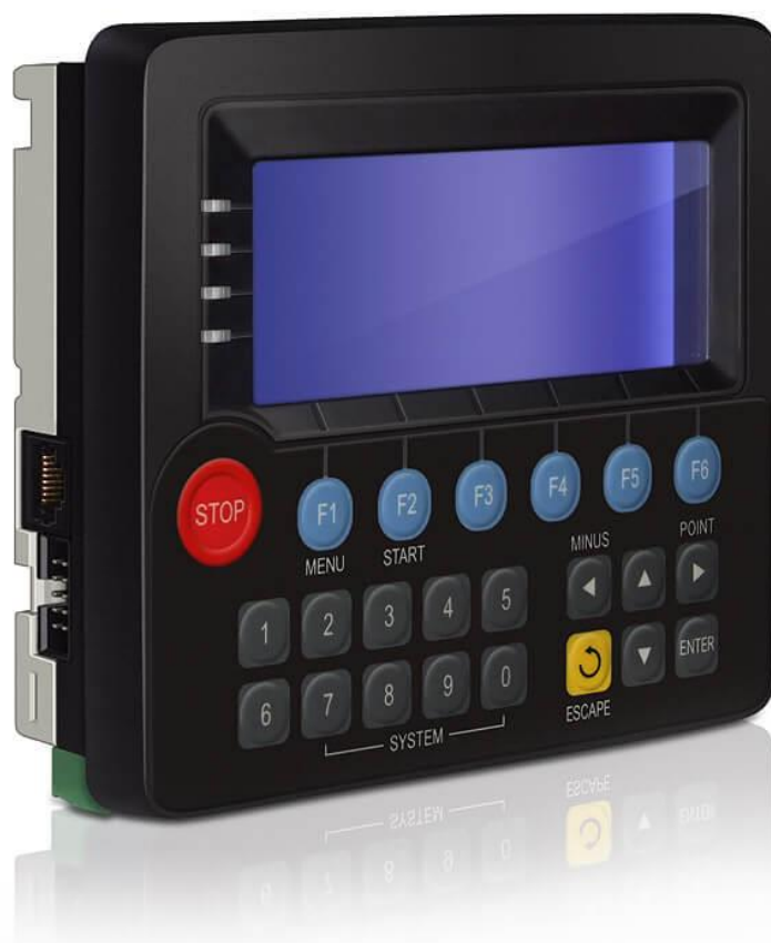
Рисунок 3.14 - Контролер Segnetics SMH2G
