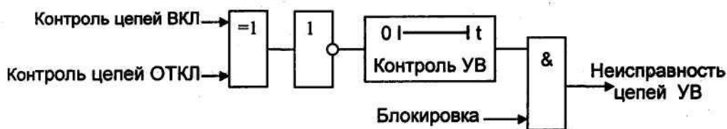
Малюнок 4.12 Функціональна схема блоку контролю несправності ланцюгів управління вимикачем
