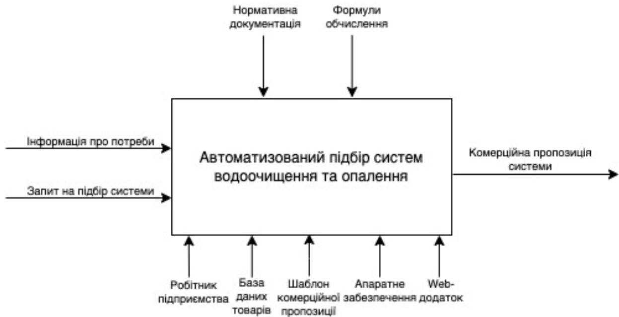
Рисунок 2.1 – Контекстна діаграма процесу автоматизованого підбору систем
