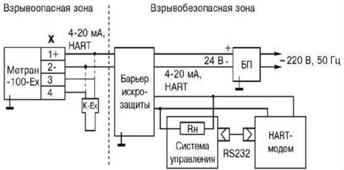
Рисунок 1.4 Датчики МП2, МП3 з бар'єром іскрозахисту і гальванічною розв'язкою сигнальних кіл і кіл живлення
