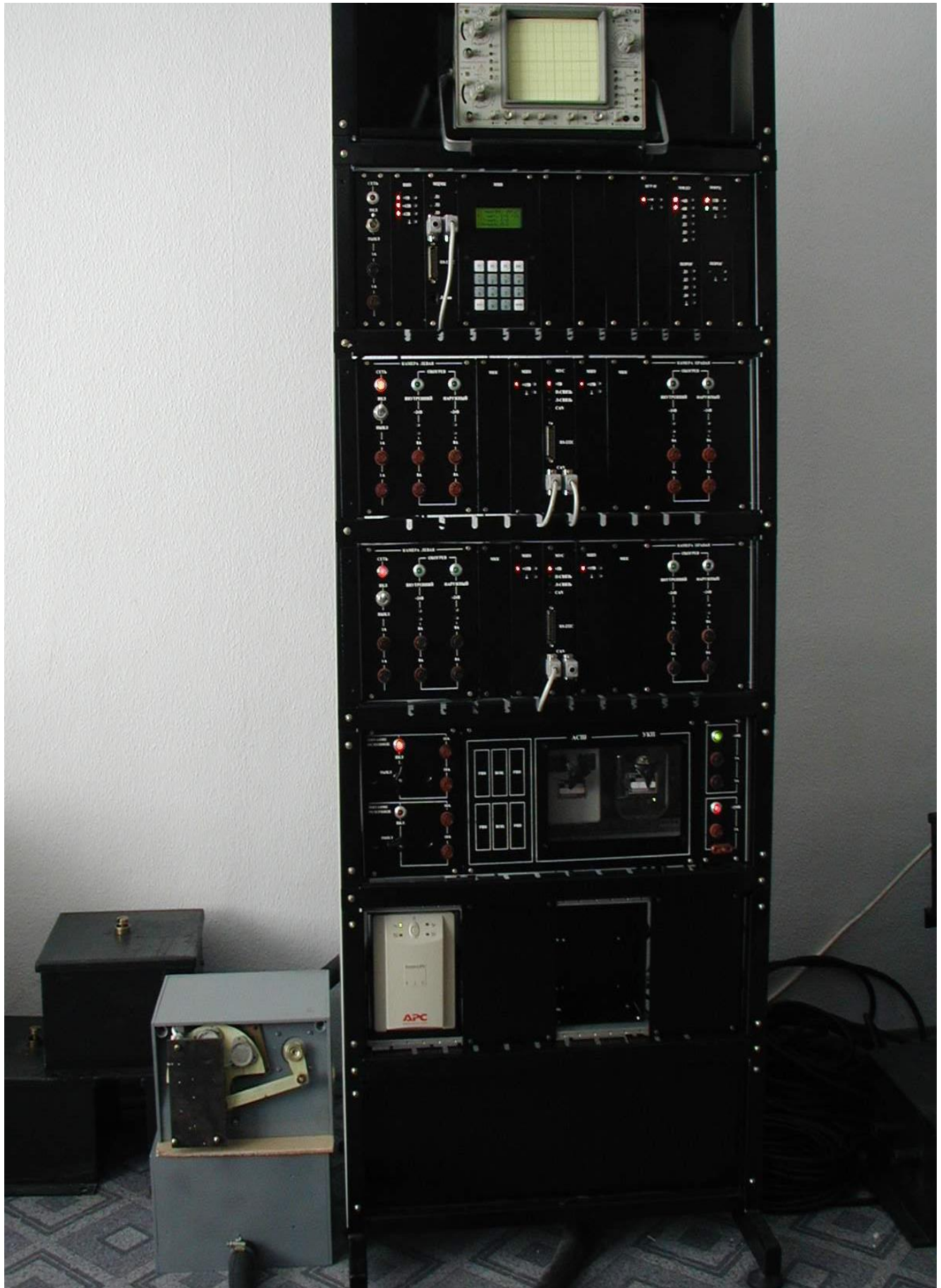
Рисунок 3.5 — Зовнішній вигляд стійки керування перегінним устаткуванням
