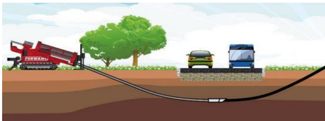
Рисунок 6 – Прокол ґрунту під дорогою з використанням установки ГСБ
