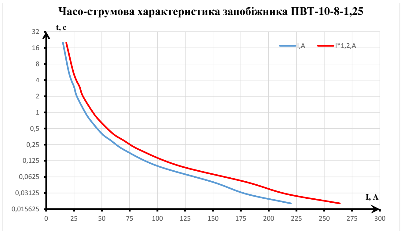
Рисунок 3.4.1 – Часо-струмова характеристика запобіжника ПВТ-10
