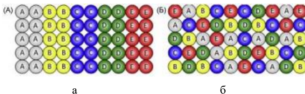
Рисунок 1.1 – Схематичне зображення розташування п'яти компонент у еквіатомному співвідношенні перед змішуванням (а) та після змішування з утворенням простого твердого розчину (б) [27]
