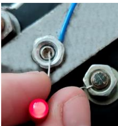
Рисунок 4.8 – Фото працюючої електрохімічної комірки при використанні аноду на основі Zn/ZnO/NiO
