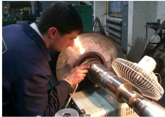
Рисунок 4.4 – Нанесення методом ЕІЛ на підшипникову шийку валу відцентрового компресора приробітного покриття
