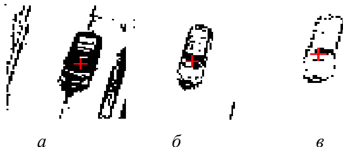
Рисунок 2.4 – Результати програми центрування автомобіля при різних квантування яскравості (в градаціях яскравості): a - \eta = 25 ; b - \eta = 50 ; v - \eta = 75
