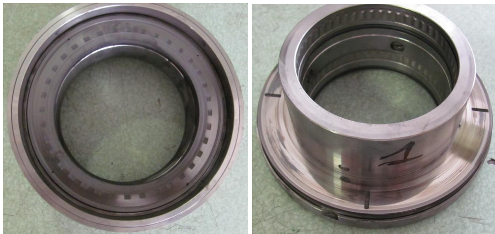
Рисунок 1.1 – Конструкція запірною імпульсного ущільнення (а) та кільця пари тертя (б)
