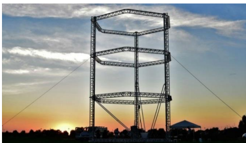
Рисунок 7.3 – 3D-принтер компанії WASP (висота 12 м, діаметр – 6 м) (Загорская, 2015)
