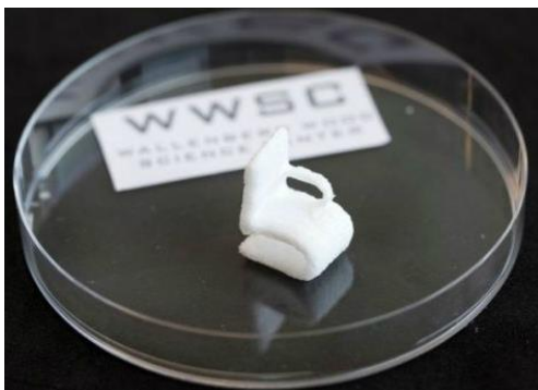
Рисунок 7.2 – Предмет, надрукований на 3D-принтері «чорнилом» із целюлози (Доронин, 2015 б)
