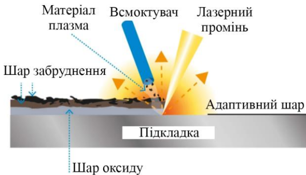
Рисунок 3.7 – Лазерне очищення поверхні
