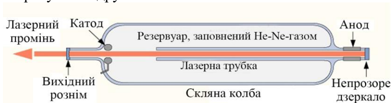
Рисунок 2.5 – Конструкція He-Ne-лазера
