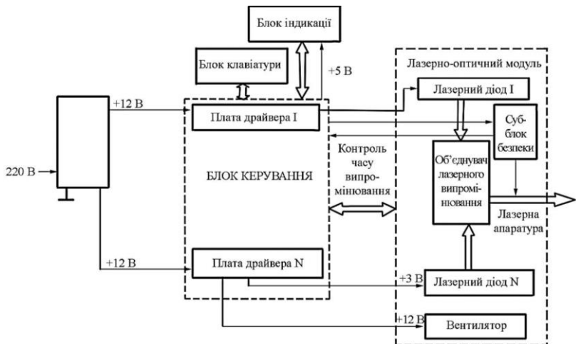
Рисунок 4.7 – Блок-схема лазерного коагулятора
