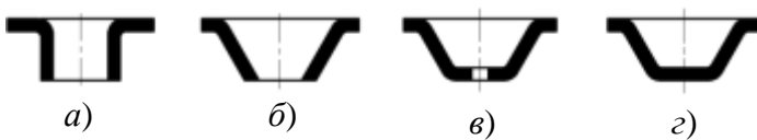
Рисунок 2.12 – Відбортування: а) нормальне; б) кутове; в) тарілчасте; г) глухе
