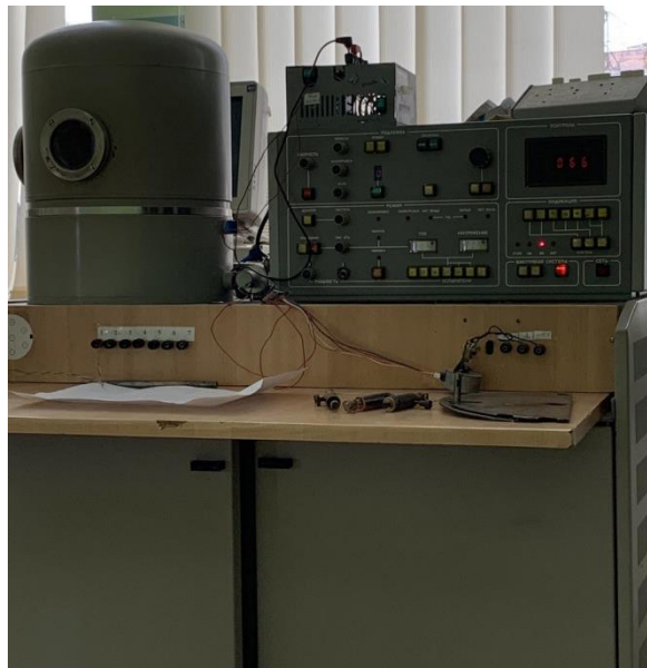
Рисунок 2.1 - Зовнішній вигляд вакуумної установки ВУП-5М
