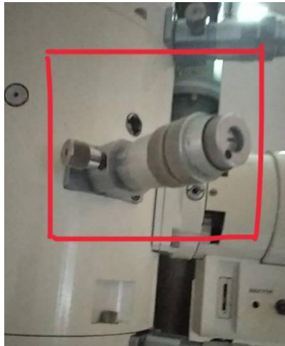
Рисунок 2.8 – Ручка введення апертурної діафрагми (прилад ПЕМ-125К)
