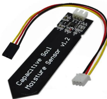
Рисунок 1.1.1. - Ємнісний датчик вологості. Адаптовано із Роботи [6].
