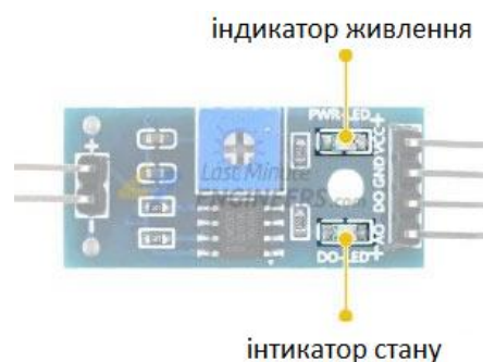
Рисунок 3.4 Світлодіодні індикатори живлення і стану ґрунту Адаптовано із роботи [22]
