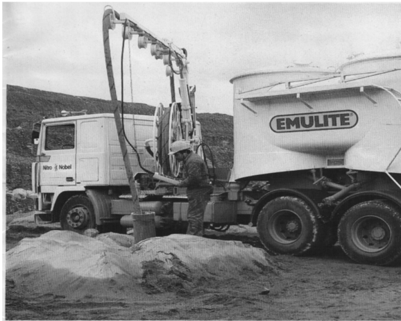
Рисунок 3.14 – Заповнення свердловин емульсійними ВР транспортно-зарядною автомашиною
