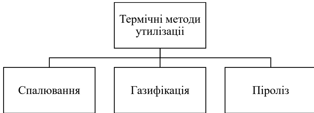
Рисунок 2.2 – Класифікація термічних методів утилізації відходів
