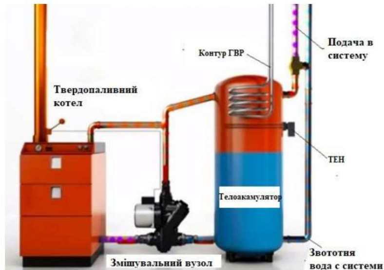
Рисунок 3.2 – Схема підключення теплоакумулятора до системи опалення
