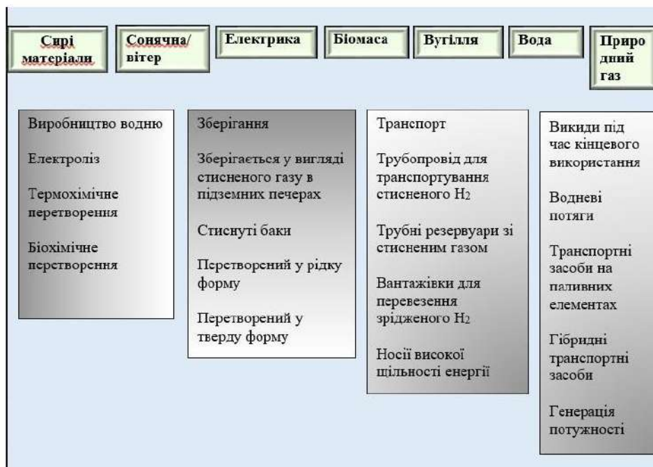
Рисунок 3.3 – Узагальнена межа системи, що використовується для проведення оцінки життєвого циклу виробництва та споживання водню
