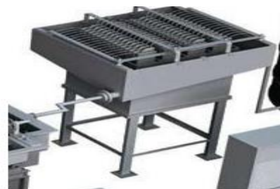
Рисунок 3.6 – Встановлення анодного окислення
