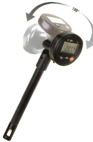
Рисунок 2.2– Термоанімометр Testo 605-N1
