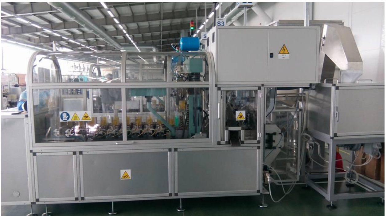
Рисунок 1.3 – Лінія з виготовлення упаковки для інших харчових продуктів у системі Guala Pack [2]
