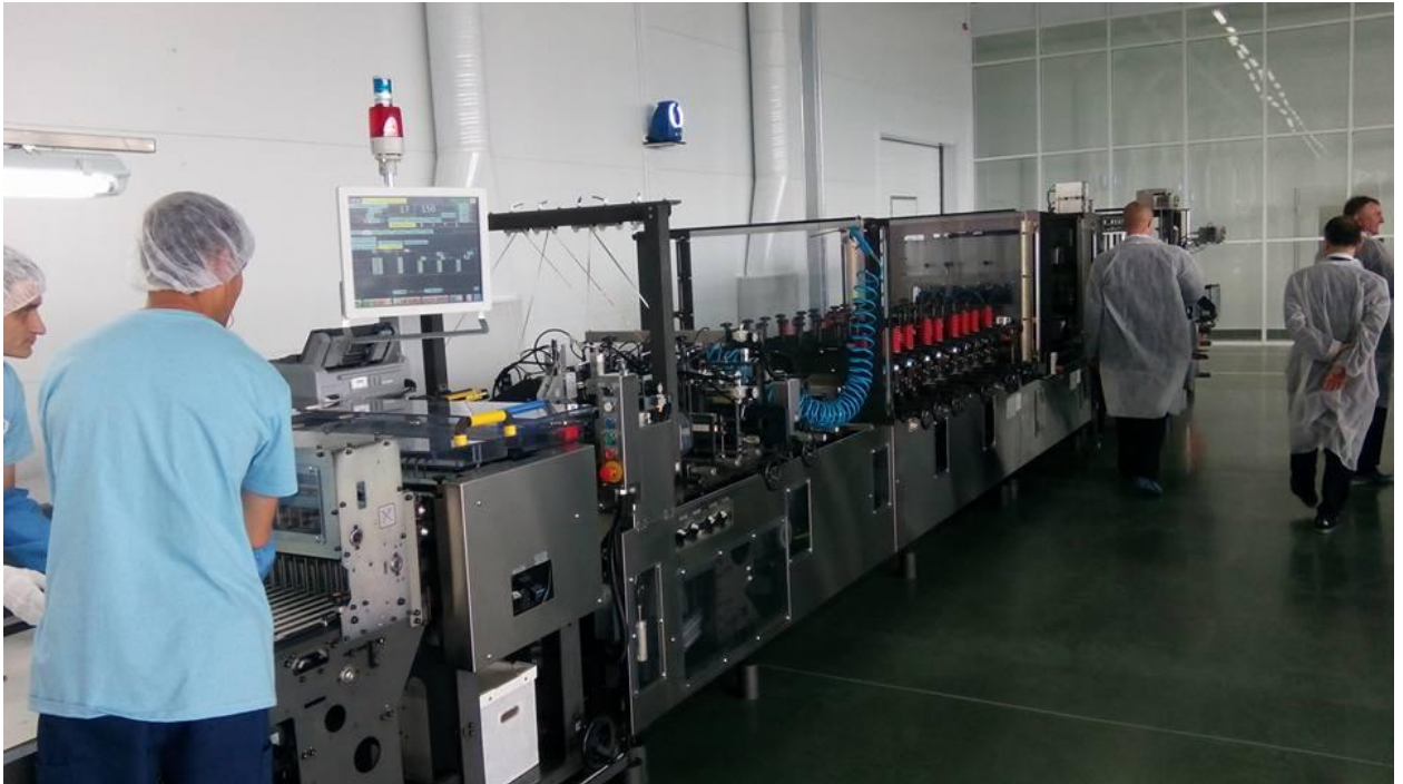
Рисунок 1.2 – Лінія з виготовлення упаковки для дитячого харчування у системі Guala Pack [2]
