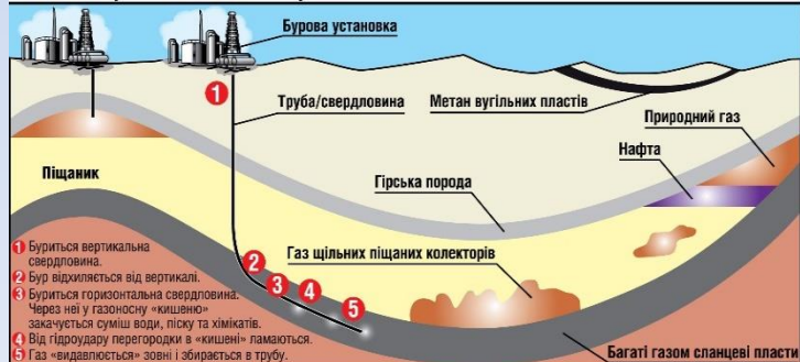
Схема видобування сланцевого газу
