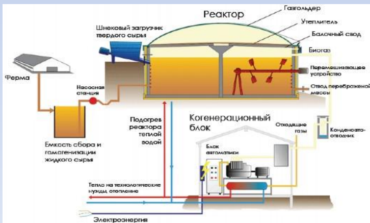
Схема біогазової установки
