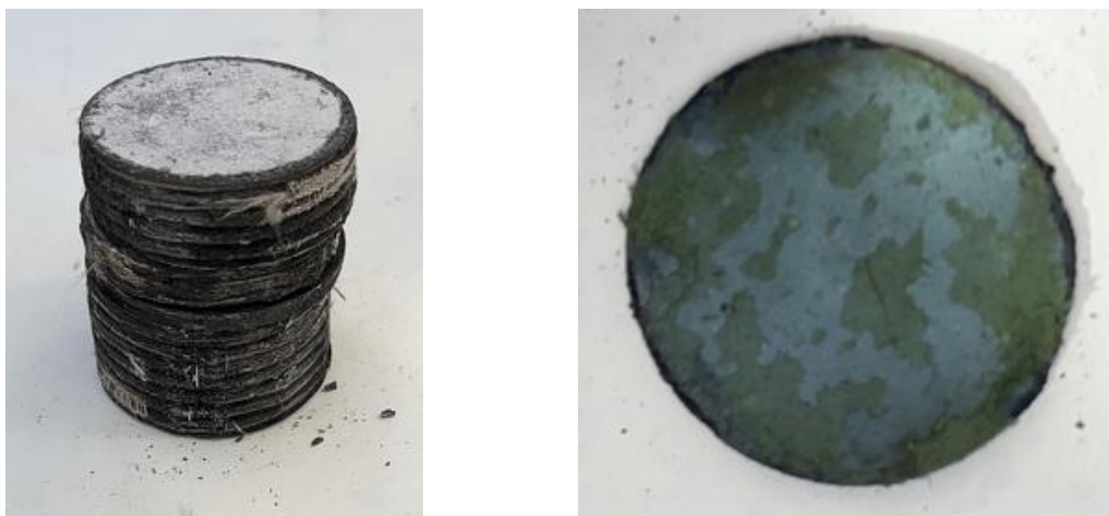
Рис.7 Шлакомісні електродні маси нанесені на диски електрохімічної системи
