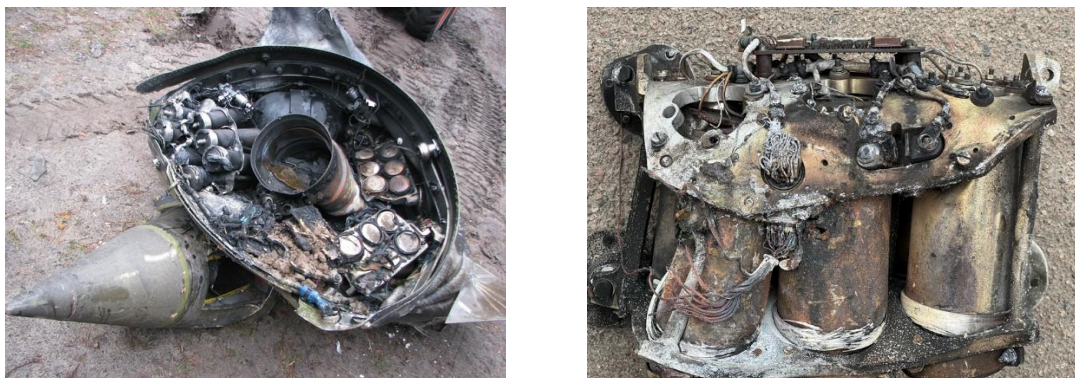
Рис. 3 Блоки теплових батарей 9Б283 у кількості 2 од
