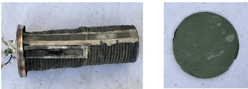
Рис. 2 Блок набірних дискових електрохімічних елементів виробу 9Б287
