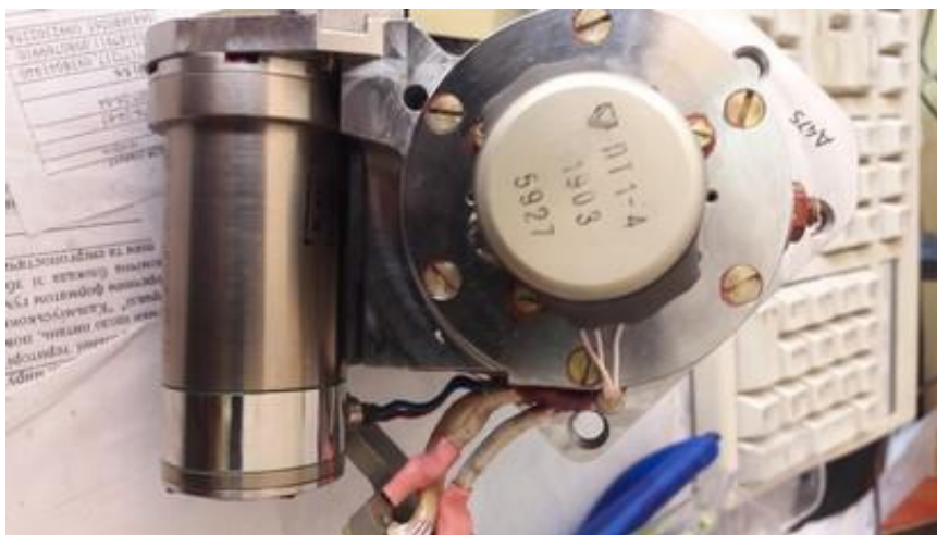
Рис. 12 Потенціометр відслідковування положення рулів рульових машин виробу 9М549 «Торнадо-С».
