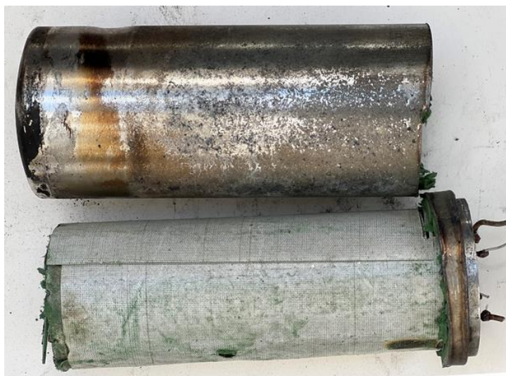
Рис. 4 Батарея 9Б283 після розкриття корпусу
