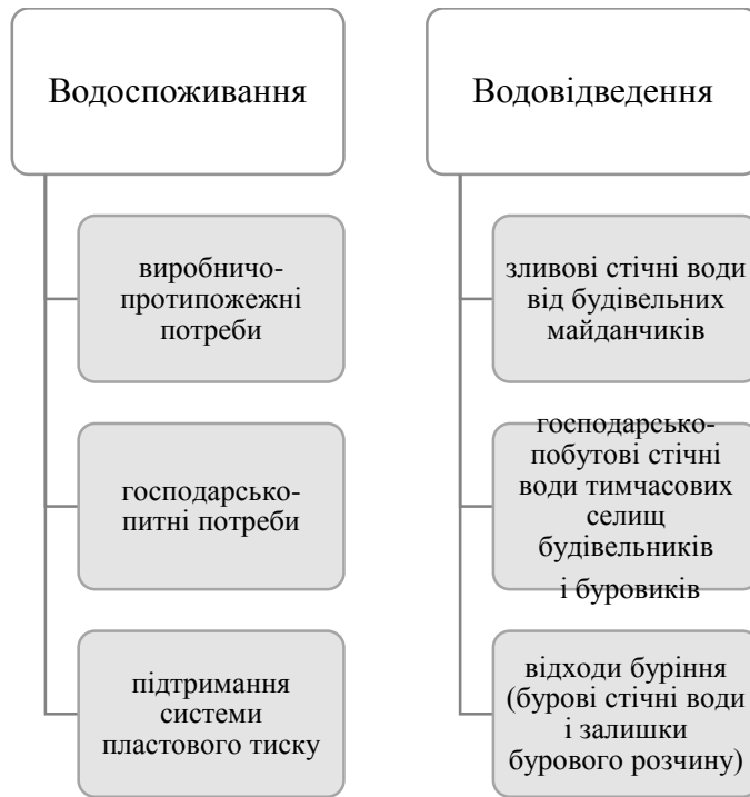
Рисунок 1.7 – Характеристика потреб водопостачання та водовідведення під час будівництва й експлуатації свердловин
