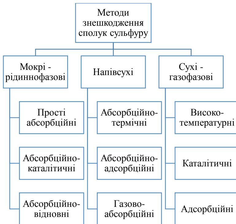
Рисунок 4.1 – Класифікаційна схема процесів десульфуризації супутнього нафтового газу [4]
