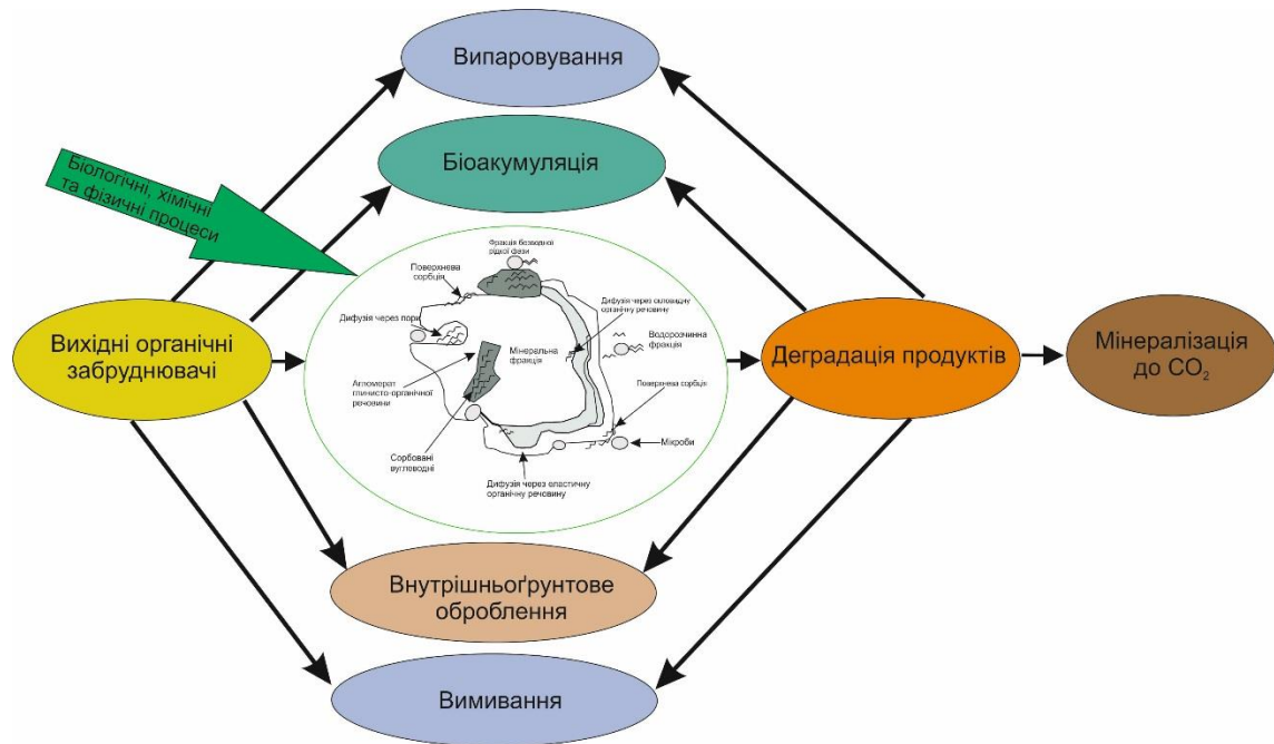
Рисунок 5.10 – Схема деградації нафти у ґрунті під впливом різних чинників
