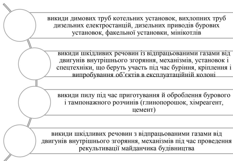
Рисунок 1.3 – Характеристика прямого впливу буріння свердловин на АП
