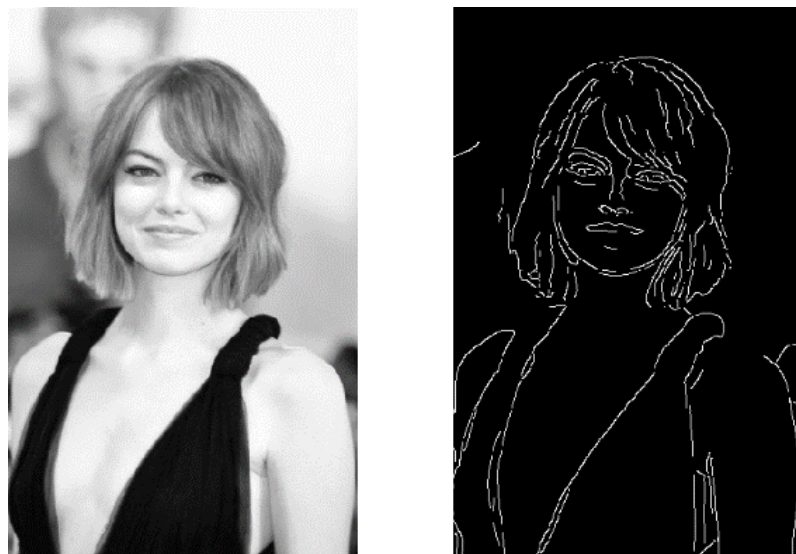
Рисунок 2- приклад зображення обробленого за допомогою методу виділення кордонів
