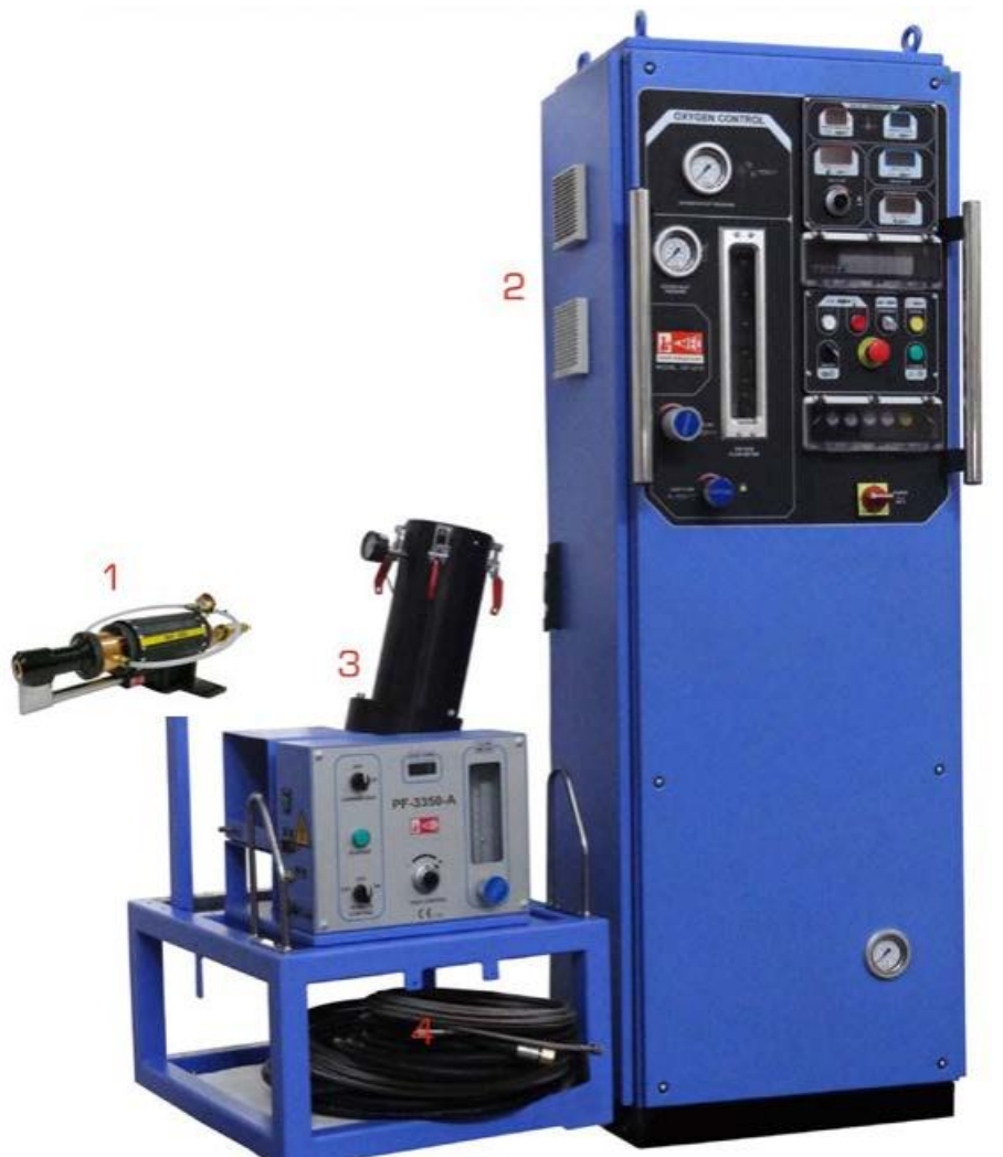
Рисунок 3.2 – Загальний вигляд установки напылення, де 1 – палик, 2 установка напылення, 3 – установка підготовки порошку.
