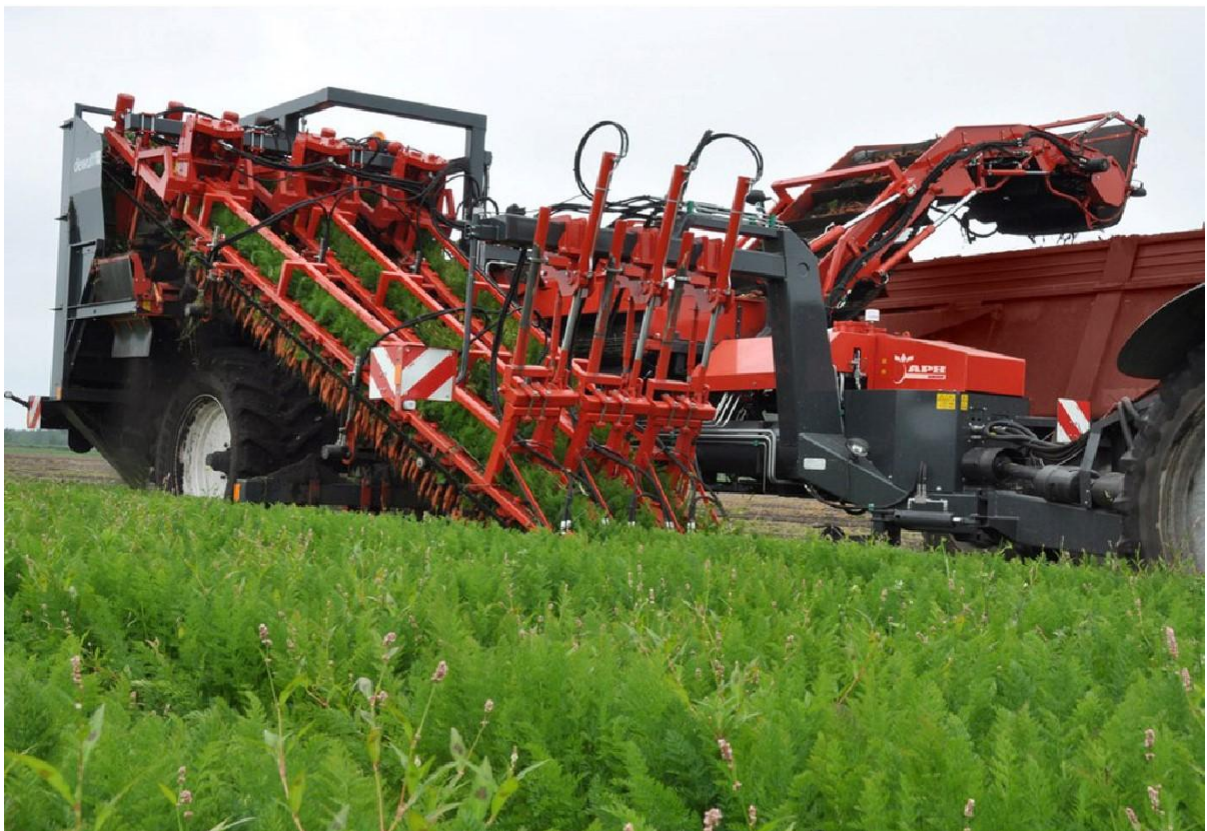
Рисунок 3.2 – Морковозбиральний комбайн Dewulf бельгійського виробництва [26]
