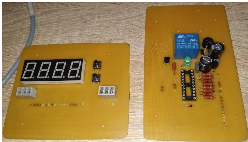
Рисунок 2.3 – Спроектвані плати пристрою під час виготовлення
