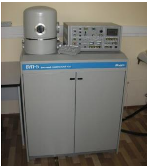
Рисунок 2.1 – Зовнішній вигляд вакуумного універсального поста ВУП-5М
