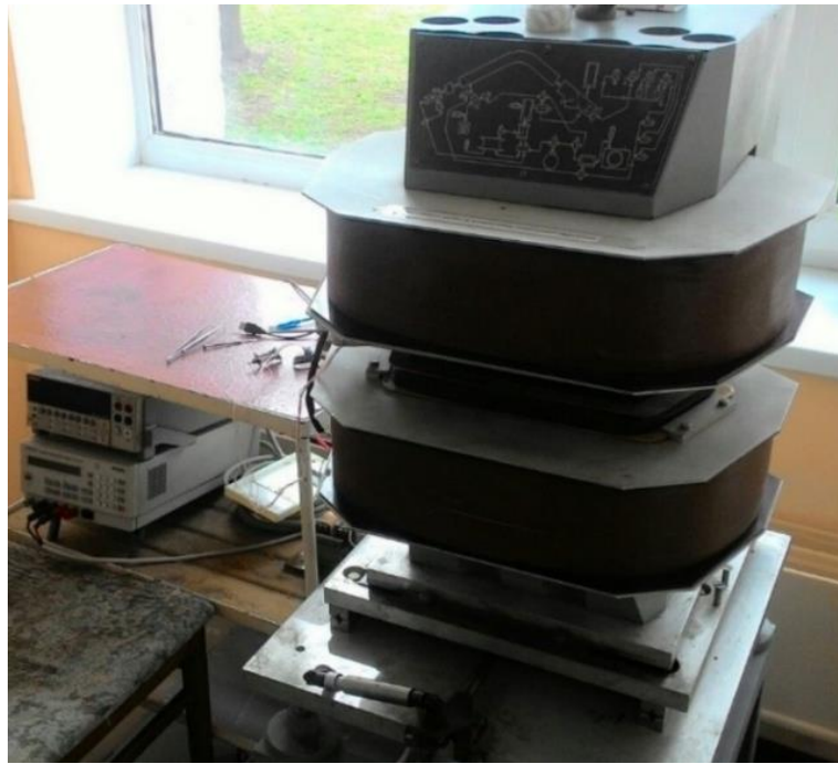
Рисунок 2.5 – Зовнішній вигляд автоматизованого комплексу для дослідження магніторезистивних властивостей [20]
