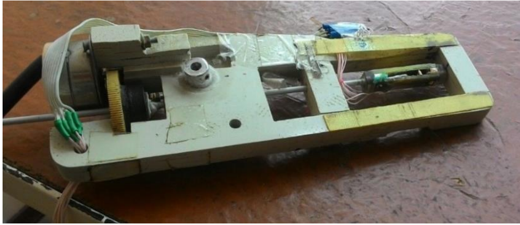
Рисунок 2.7 – Тримач для вимірювання МО [20]
