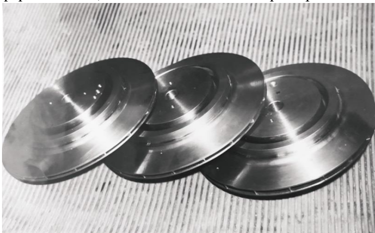
Рисунок А.12 – Робочі колеса з каналами, виконаними електроерозійним методом
