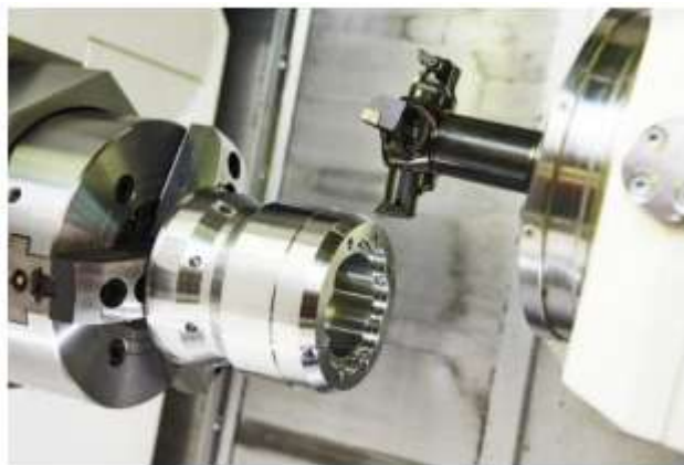
Рисунок 1.6 – Обробка на токарно-револьверному верстаті
