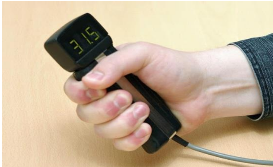
Рис. 2.9. Електронний динамометр для вимірювання сили кисті
