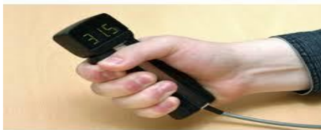
Рис. 2.6. Прилад для вимірювання і відтворення м'язових зусиль сильнішої руки
