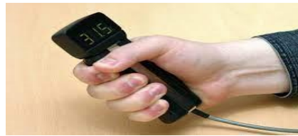
Рис. 2.1. Електронний динамометр психодіагностичного комплексу «НС-Психотест»
