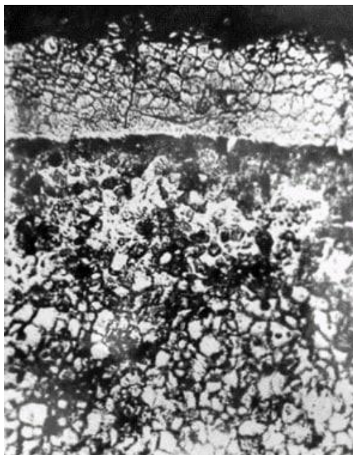
Рисунок 3.5 – Структура сталі 14X17H2 після азотування
