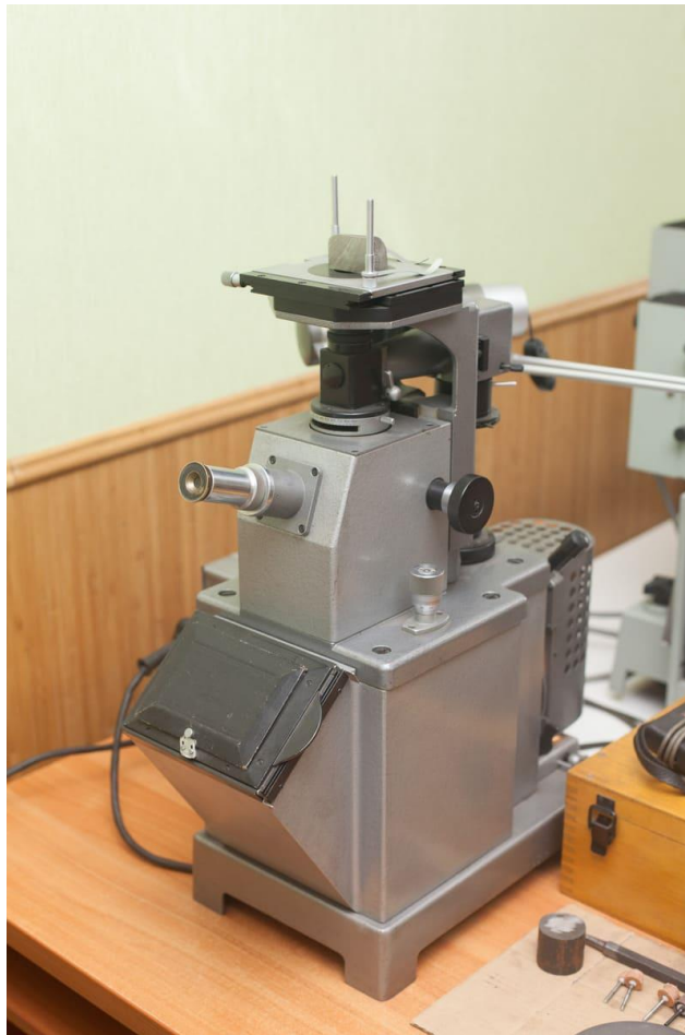
Рисунок 2.4 – Металографічний мікроскоп МІМ-7 (фото) [23]
