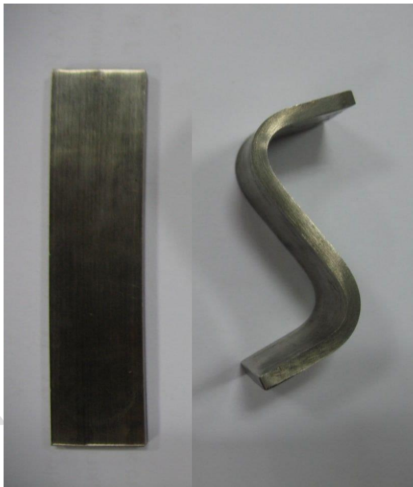
Рисунок 3.11 – Зразки сталі 14X17H2 до та після дослідження стійкості до МКК
