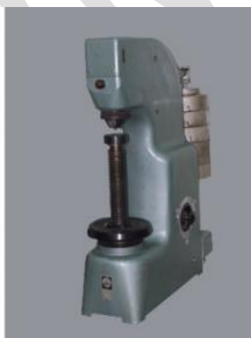
Рисунок 2.5 – Прилад ТШ-2М (фото) [25]
