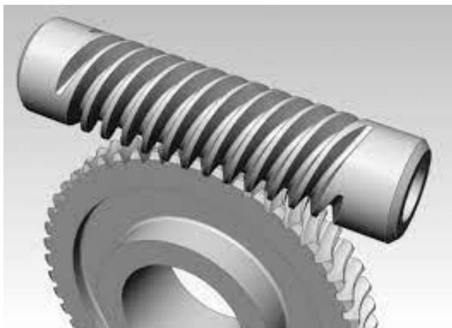
Рис 3.3 – Приклад будови черв'ячної передачі
