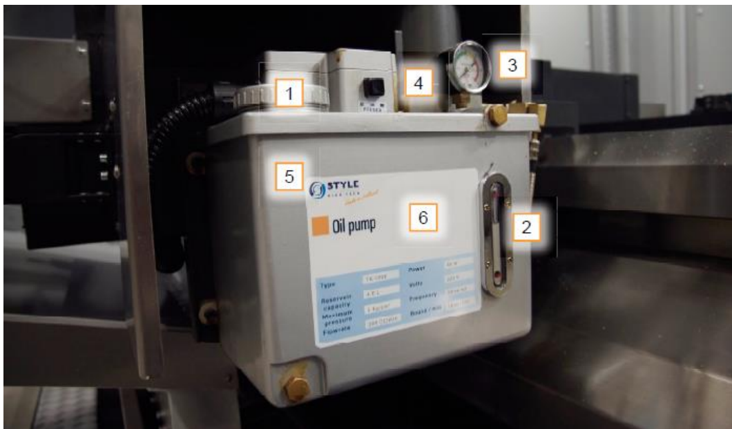
Рисунок 1.4 – Компоненти масляного насосу:
