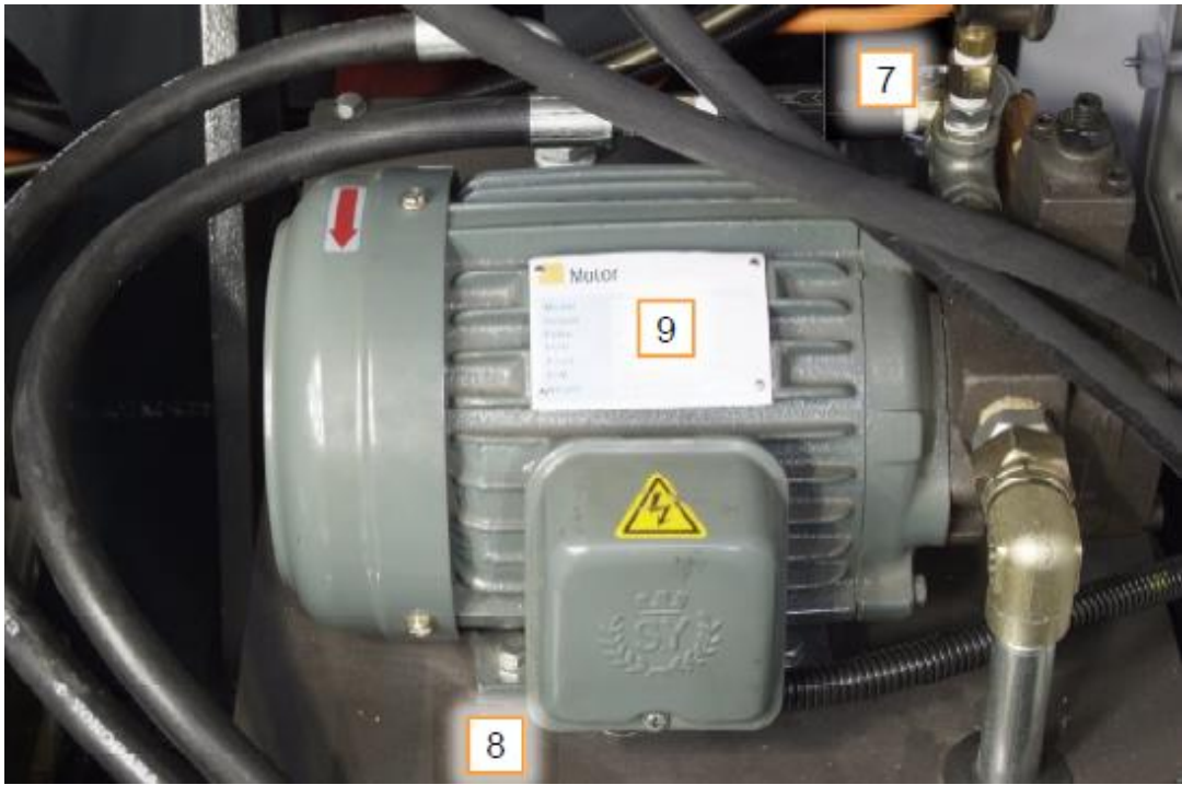
Рисунок 1.5 – Зовнішній вигляд насосу для подачі МОР: 7 – тиск; 8 – резервуар; 9 – характеристики.
