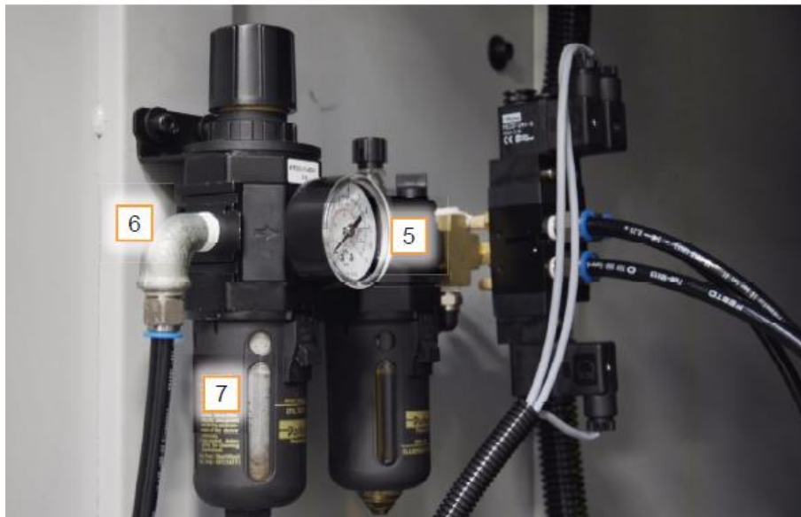
Рисунок 1.7 – Насос для подачі повітря: 5 - тиск повітря; 6 – підключення пневматичної магістралі; 7 – ковпачок.
