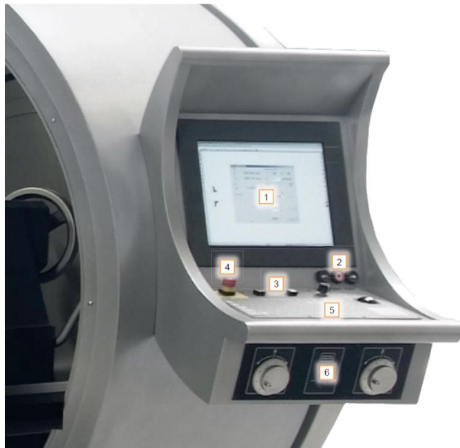
Рисунок 1.3 – Пульт керування верстату Style 750: 1 – рідкокристалічний екран; 2 – управління стружкоуборочним конвеєром; 3 – перемикач вкл/викл; 4 – аварійна кнопка; 5 – клавіатури; 6 – колеса позиціонування.
