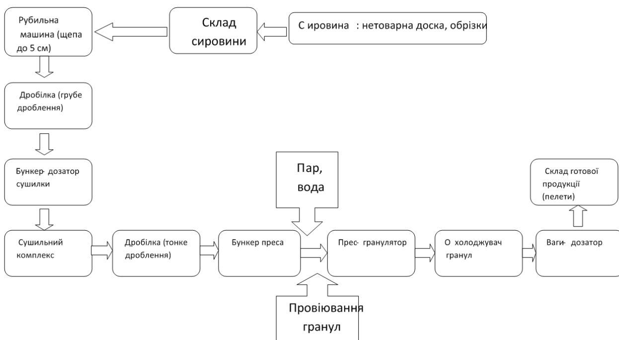
Рисунок 2.13. Блок-схема виробництва пелети з обрізків деревини, нетоварної деревини
