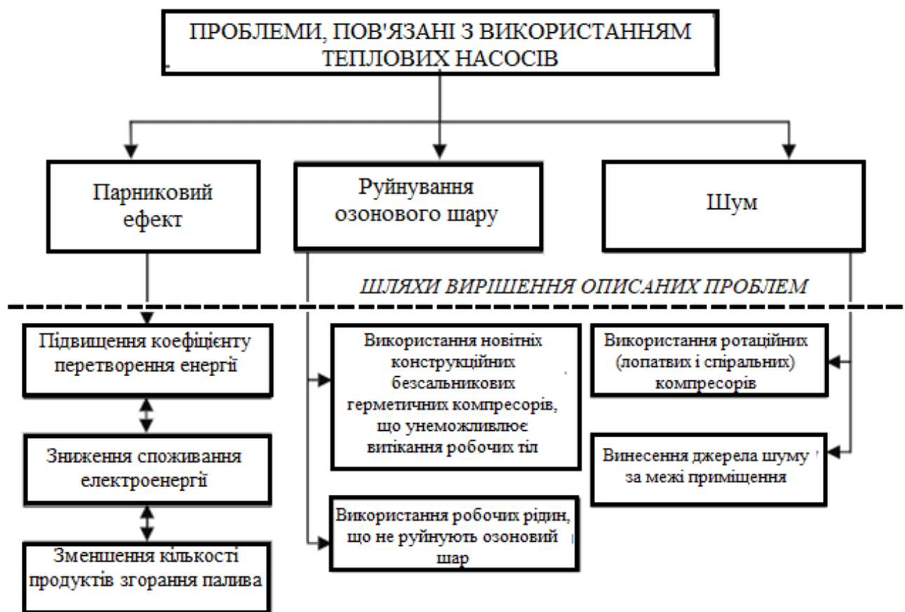
Рисунок 1.6 – Проблеми використання теплових насосів та шляхи їх вирішення
