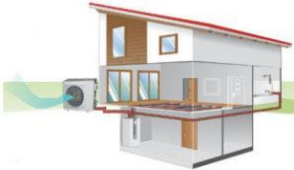
Рисунок 1.4 – Приклад застосування повітряного теплового насоса (повітря-вода)
